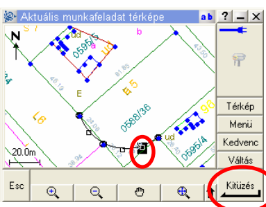
Ív felosztása, ill. az osztópont azonnali kitűzése DXF térképről
